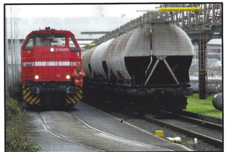
Bild 9: Anlieferung des Braunkohlenstaubs ins Kraftwerk (Foto: Klais)
